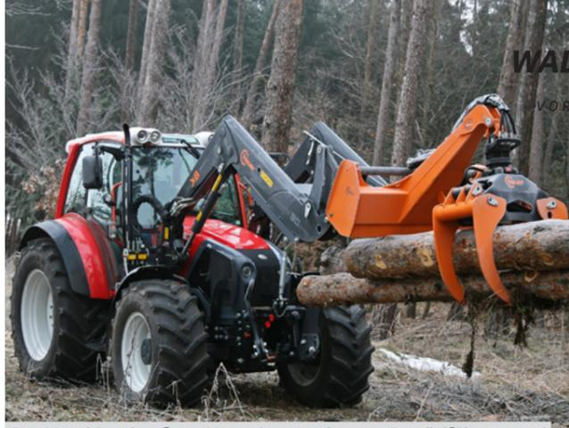
Der Maschinenbauern Hauer ist es gelungen, Parallelführung und Kippzylinder in die Frontladeschwinge zu integrieren.
