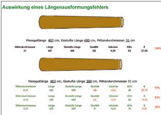
Abb. 3: Fehler bei der Ausformung können den Erlös eines Bloches um 70 % reduzieren.
